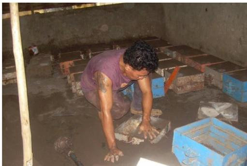
**Gambar 2.** Proses pembuatan pasir cetak dengan pola coran
