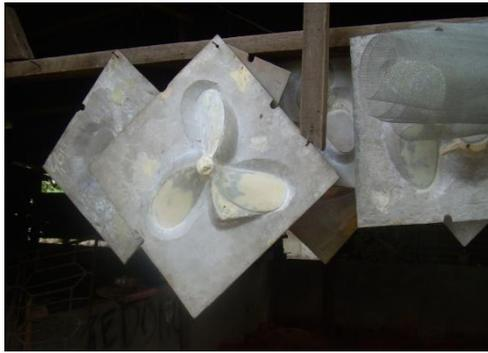
**Gambar 1.** Pola yang telah siap untuk digunakan dalam proses cetakan
